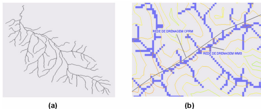
Figura 21 - Rede de drenagem; (a) rede de drenagem da CPRM; (b) Rede de drenagem com alto valor de ramificações no WMS.
